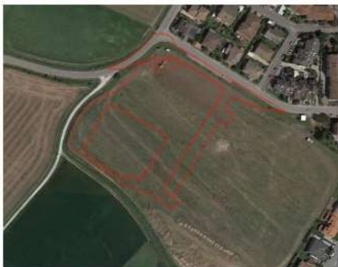
Fig.3.8: Consumo di suolo per la realizzazione di un nuovo supermercato di generi alimentari nel comune di Montagnana (PD) in un'area complessiva di 13.400 m 2 di cantiere, di cui 3.550 m 2 occupati dall'edificio del supermercato e 9.850 m 2 occupati da aree impermeabilizzate per parcheggi e nuova viabilità (immagine 2018 a sinistra, 2020 a destra). Nell'area a destra risultano inoltre visibili delle attività di movimentazione terra, probabile nuovo consumo di suolo nei prossimi anni.
