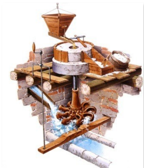
Funzionamento del sistema di macina
